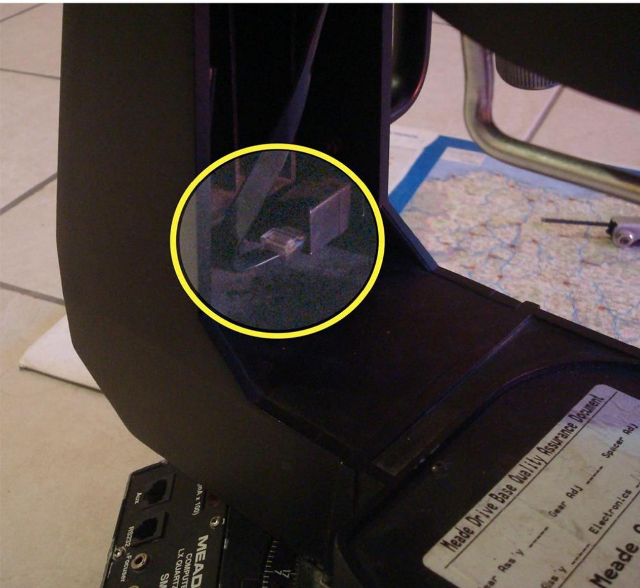
**Ascension Droite** : Insérer le moteur **AD** dans la base et le refixer (2 vis à 6 pans)
