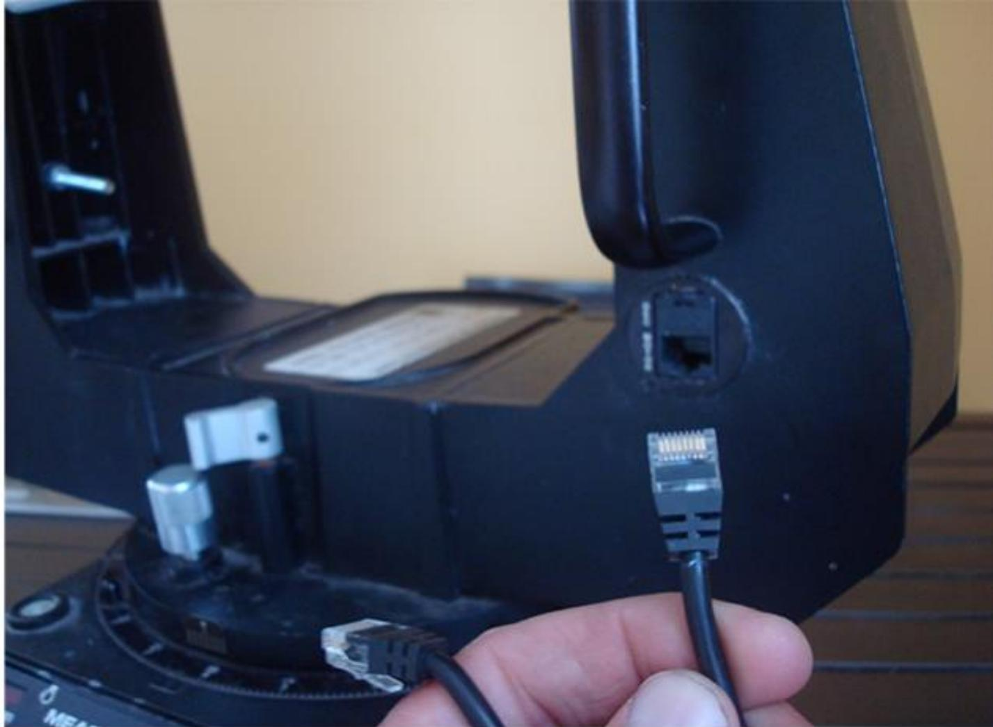
**Débrancher le câble du moteur DEC côté intérieur de la fourche**
