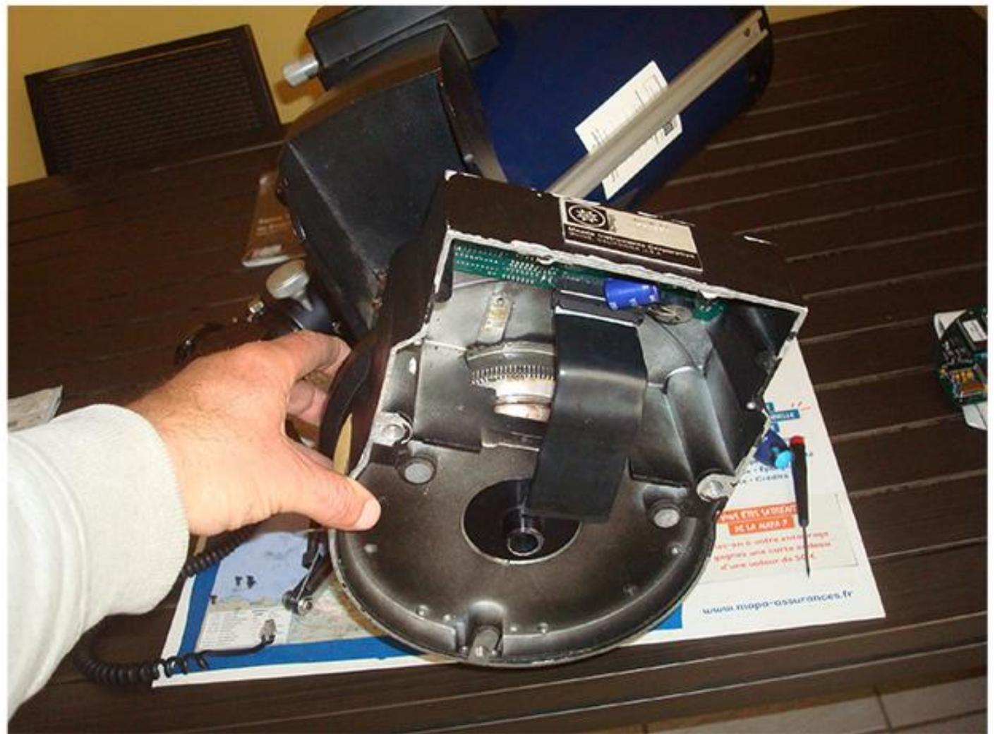
Information → Emplacement des trous de fixation du moteur AD une fois le moteur retiré
